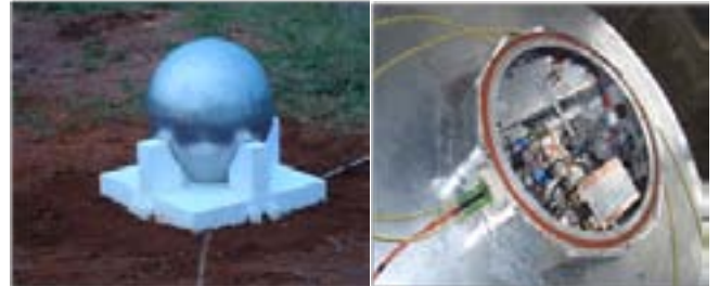
चित्र 2. (दाई ओर) (उपर) गोलाकार एकलघुवीय एंटीना को 40-200 मेगा हर्ट्ज के दायरे वाली आवृत्तियों में कार्य करने के लिए डिजाइन किया गया है। (नीचे) अग्रमुखी इलेक्ट्रॉनिक्स को एंटीना के नीचे लगाया गया है।
