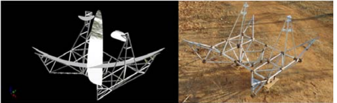
(बाईं ओर) बैकअप संरचना का दर्पणों के साथ CAD मॉडल दृश्य, (दाईं ओर) ईएलआई, 2.3 x 2.3m के पैमाने वाले मॉडल का चित्र, जिसे गौरीबिदनूर में निर्मित किया जा रहा है।
