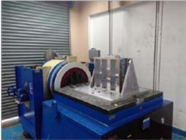
चित्र 9. पोलिक्स संसूचक का यांत्रिकीय दोलन के दौरान स्पंदन परीक्षण
