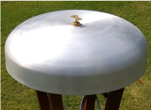
चित्र 7 (बाएं) लॉग-सर्पिल परावर्तक आधारित सप्टक बैंड चौड़ाई आवृत्ति मुक्त द्विध्रुवीय एंटेना
