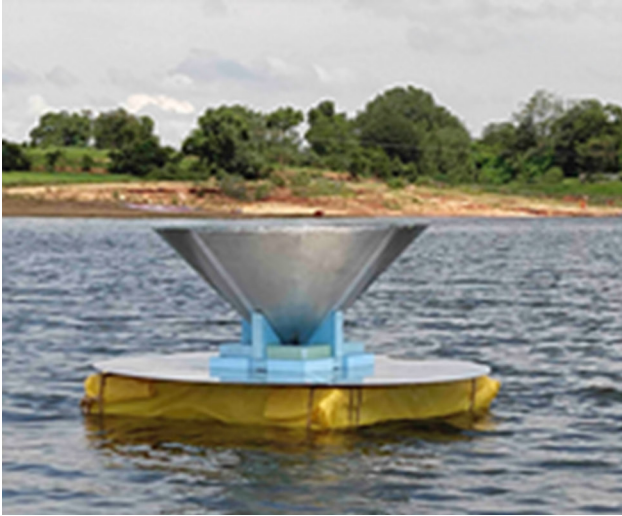
चित्र 1. (बाएं) एक झील के पानी की सतह पर तैनात बेड़ा के साथ शंकु-डिस्क एंटीना की तस्वीर। चित्र 2. (दाएं) एंटीना की मापी गई कुल दक्षता। WIPL-D और FEKO विद्युत चुंबकीय मॉडलिंग से अपेक्षित क्षमताएँ भी दिखाई गई हैं। वास्तविक पृथ्वी पर मापी गई कुल दक्षता भी तुलना के लिए दिखाई गई हैं।
